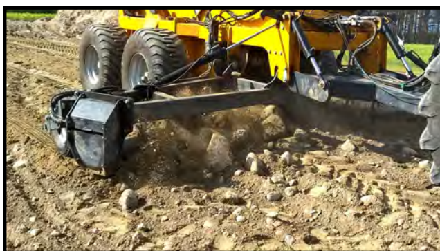
Ramasse les pierres allant de 2.50 à 40 cm
